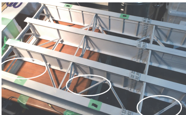
図-7 横構(左)と分配横桁(右)
