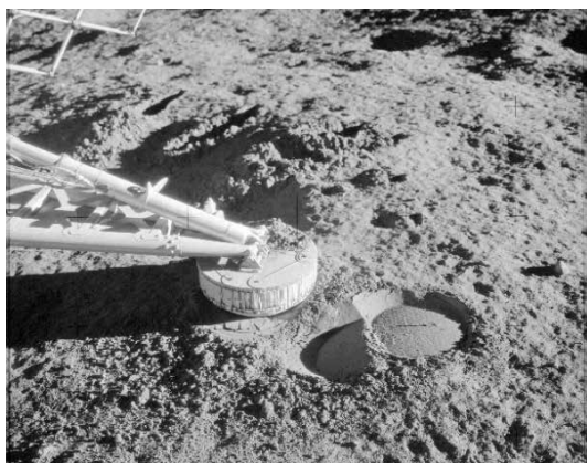
写真-1 アポロ 12 号宇宙飛行士が撮影したサーベイヤー 3 号の着陸機パッド 2)
