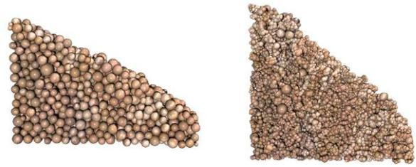
図-6 安息角シミュレーション結果(左:球形粒子、右:10要素 FJS-1 モデル)<sup>11)</sup>
