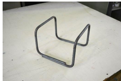
3 次元状に折り曲げ加工された キャップタイ（タイプ II）
