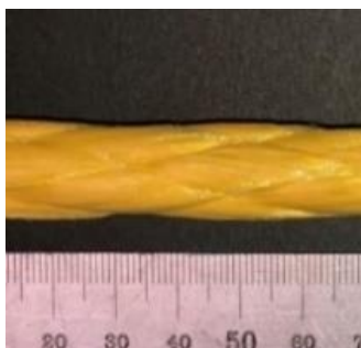
図 4.2.2 組紐型アラミド FRP 補強筋の表面形状
