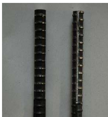
図 2.5 研磨した鉄筋端部の外観
