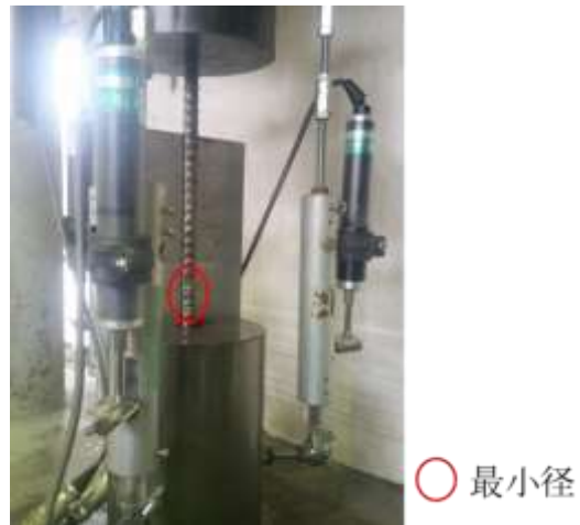
図 6.5 試験体の固定方法
