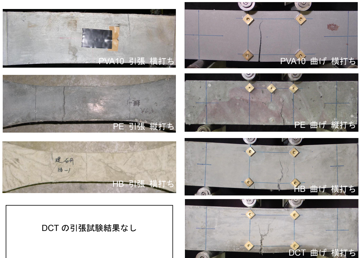
図 6.2 ひび割れ状況（左：引張試験，右：曲げ試験）
