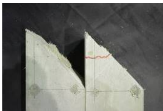
図 2.4.3 切欠き部外ひび割れ
