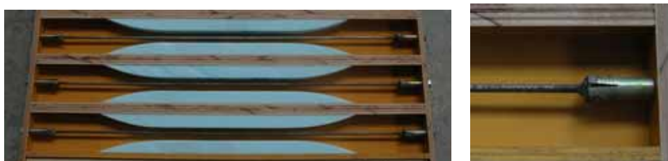
図 3.3 型枠および鉄筋接合状況
