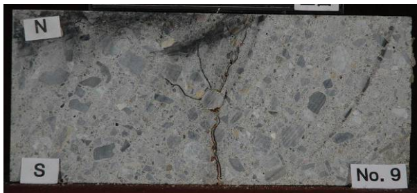
付写真 1-11 D16CF35-B2 の腐食ひび割れ状況
