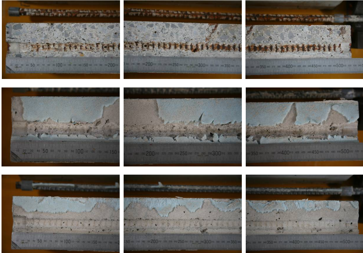
写真 3-4 引抜試験後の試験体の破壊状況 (上 : CF25-A-1、中 : CF25-N-1a、下 : CF25-N-1b)
