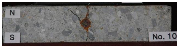
付写真 1-7 D16CF15-B2 の腐食ひび割れ状況
