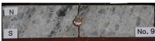
付写真 1-7 D16CF15-B2 の腐食ひび割れ状況
