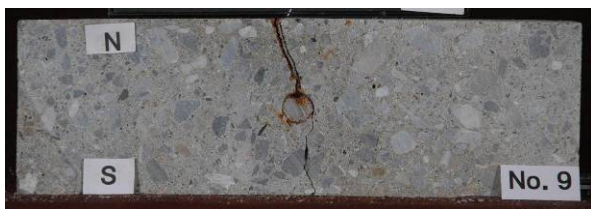
付写真 1-9 D16CF25-B2 の腐食ひび割れ状況
