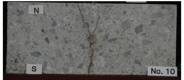
付写真 1-11 D16CF35-B2 の腐食ひび割れ状況
