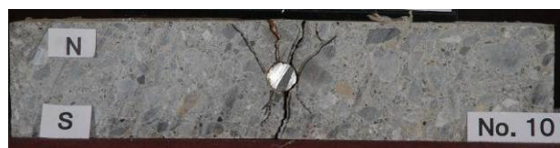
付写真 1-6 D16CF15-A2 の腐食ひび割れ状況
