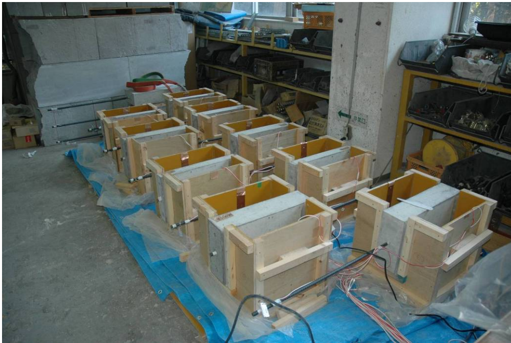
付写真 1-1 電食状況
