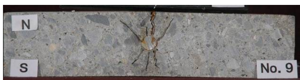
付写真 1-6 D16CF15-A2 の腐食ひび割れ状況
