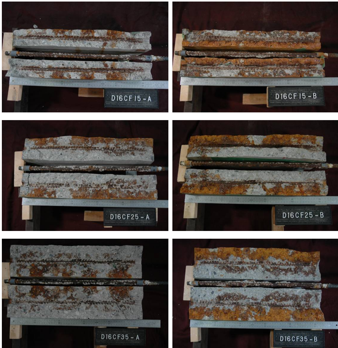
写真 2-4 引抜試験後の試験体の割裂面の様子
