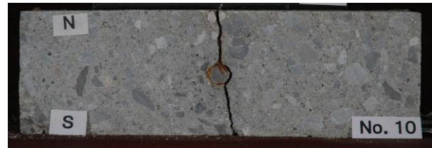
付写真 1-9 D16CF25-B2 の腐食ひび割れ状況
