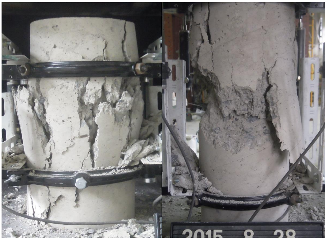
図 3.10 最終破壊状況 (左 : 300-0-N ,右 : 450-0-N)
