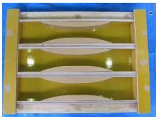
写真 3-1 実験での型枠（上：曲げ試験体 下：引張試験体）
