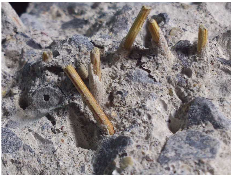
写真 2.11 曲げ供試体のひび割れ面 (S シリーズ混入率 2%)
