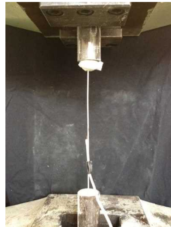
写真 2.6 竹繊維の引張試験
