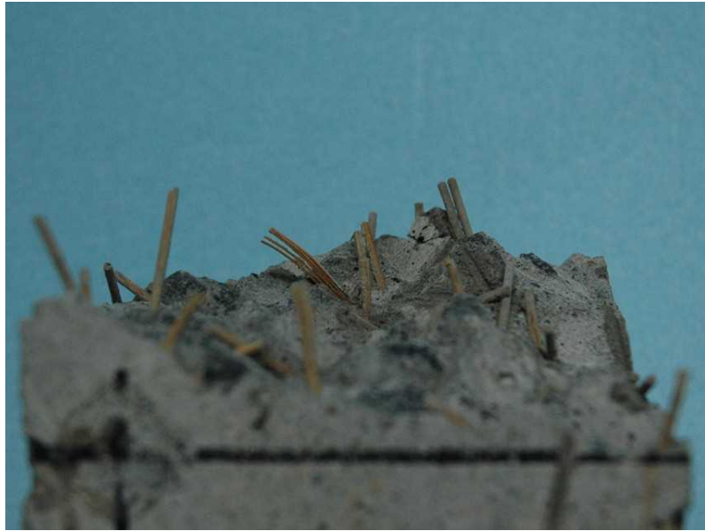
写真 2.10 曲げ供試体のひび割れ面 (N シリーズ混入率 2%)
