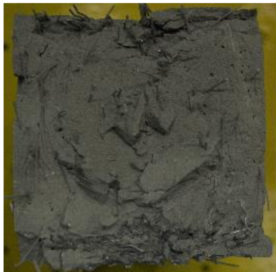
図 3.3.1 試験体断面（第 3 章）
