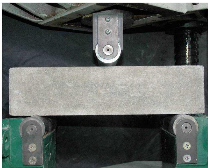
写真 3.2 曲げ試験方法
