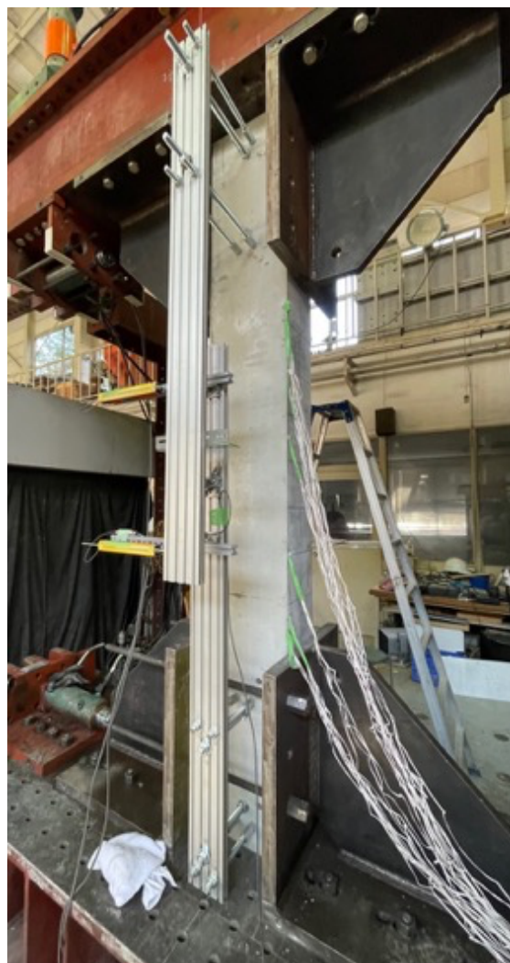
図 2.2.7 変位計設置位置（単位：mm）
