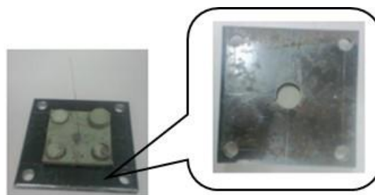
図 2.3.2 鋼板に貼り付けた試験体
