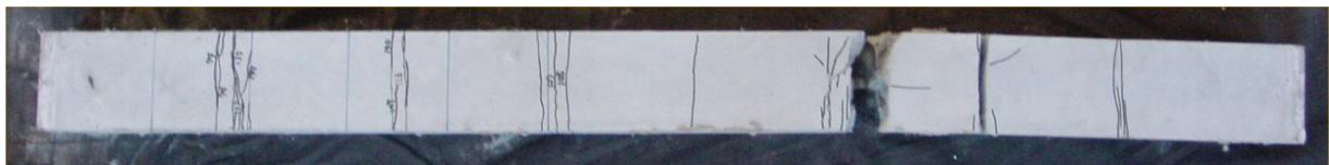
図-9 両引付着試験体破壊状況(No.2)
