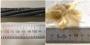
図-2 CFRP・アラミド繊維形状
