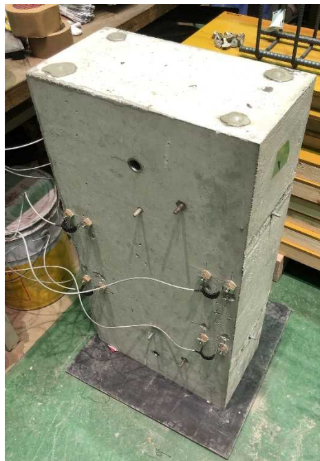
図 2.2.2 変位計設置状況
