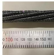
図-1 CFRP の外観
