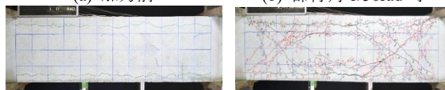
SF-Lv.1（加力前最大ひび割れ幅 0.20mm）
