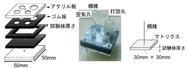
図-2 試験体および型枠形状
