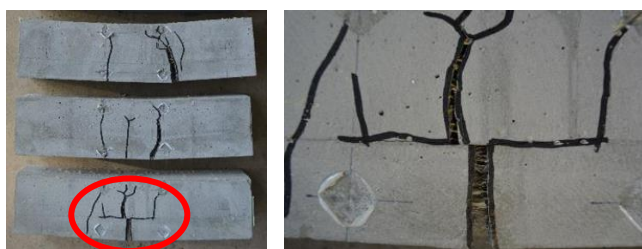
図4 加力後写真 (P3A7)
