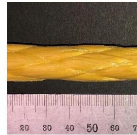
図-2 組紐型アラミド FRP 補強筋
