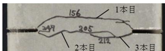
図-13 試験体ひび割れ発生過程
