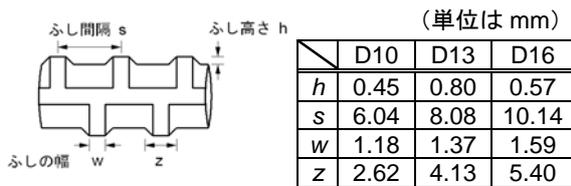
図-3 鉄筋形状
