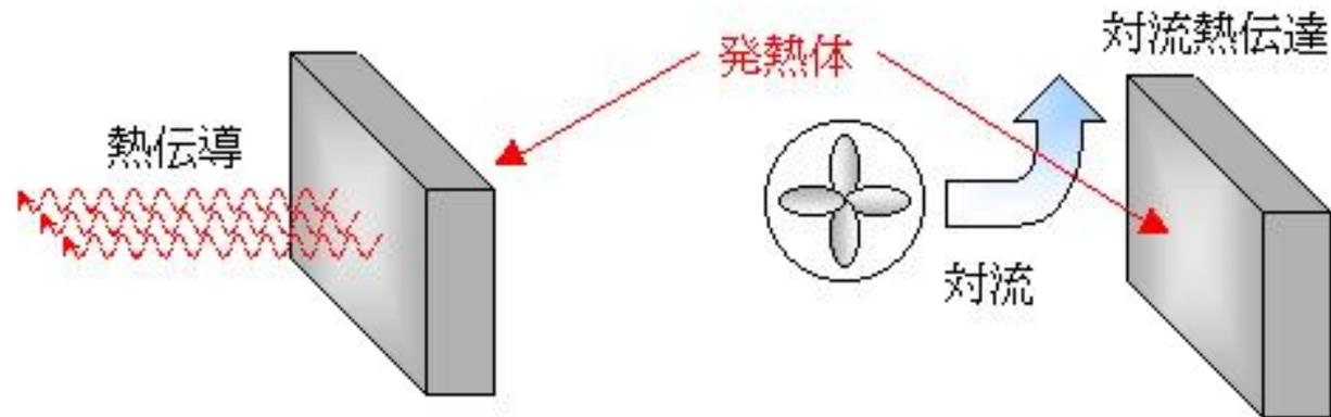
高温発熱体表面を流れる空気の流速によって熱移動が異なる！ ➡ なぜ？
