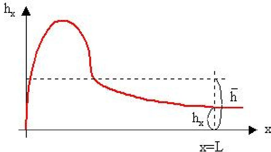
次式によって求められる熱伝達率は、板の前線からの距離 $x$ によって変化する局所的な値である。
