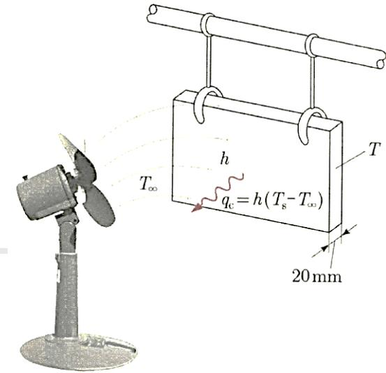
図に示すように、厚さ20 mm の十分大きい炭素鋼板が均一温度 $T_i = 800$  K に加熱された後、 $T_\infty = 300$  K の空气中で冷却される。空気との熱伝達率を  $h = 80$  W/(m<sup>2</sup>·K) とすると、 $T = 550$  K となる時間を推定せよ。ただし、炭素鋼板の熱伝達率  $k = 43$  W/(m·K)、代表長さ  $L = 0.02$  (m)、熱拡散率を、 $\alpha = 1.18 \times 10^{-5}$  (m<sup>2</sup>/s) とする。また、ビオ数  $Bi \ll 1$  のとき、集中熱容量モデルとして以下の式を用いてよい。
