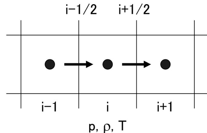
この系では物理学的直感によく訴える。圧力 $p_{i-1}$ と $p_i$ の圧力差によって流体運動が生じ $u_{i-1/2}$ が駆動される。また、セル中心の密度は $\rho_{i-1/2}$ で運び込まれる質量と $\rho_{i+1/2}$ で運び出される質量によって蓄積量が定まると考えたのである。
