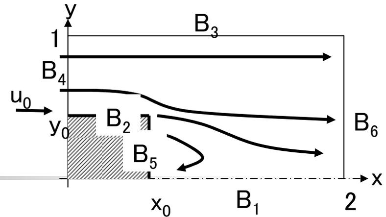
$B_1$ は中心線とし、 $B_2$ と $B_5$ はそれぞれ障害物の上面と底面とする。
