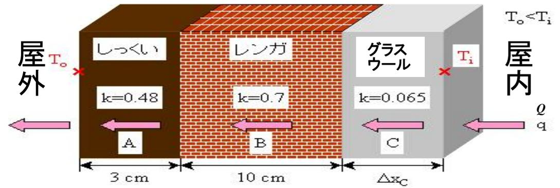
グラスウールがない場合:  $Q_0 = \frac{T_i - T_o}{\frac{1}{A} \left( \frac{\Delta x_A}{k_A} + \frac{\Delta x_B}{k_B} \right)}$
