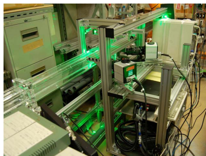
円管と計測装置。高速カメラ2台と高速レーザを用いて、秒間1000枚の粒子画像を撮影することが可能。レーザシートを断面面に照射することで、断面内の速度3成分を時系列で計測する。
