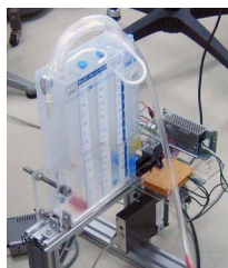
ドレナージュユニットと流量計測装置。空気の通過に伴い水封部（水色の液体が溜まっている部分）に気泡が発生する。その気泡の有無を電子的に捉え、流量を求める。
