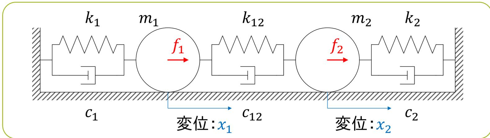
$$m_1 \ddot{x}_1 = f_1 - k_1 x_1 - c_1 \dot{x}_1 - k_{12}(x_1 - x_2) - c_{12}(\dot{x}_1 - \dot{x}_2)$$
