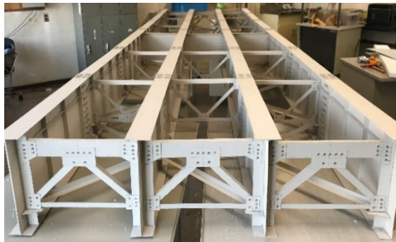
図6 橋梁模型（床板無し）
