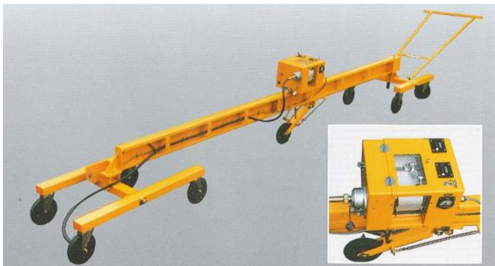
図 5-5 3m プロフィールメーターの外観図
