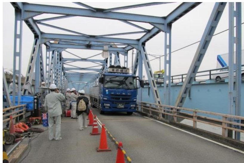
※ 旧鳥飼大橋(トラス橋)における実車走行実験の様子
