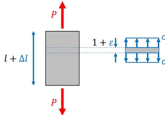
□ 応力とひずみの定義式を代入 ➡ 解
