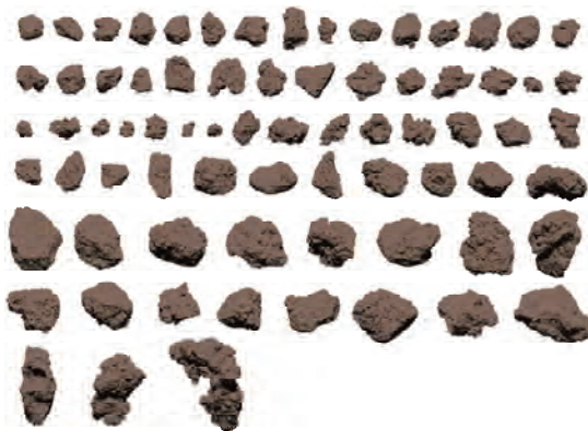
図2：CTイメージから再構築した74個の月面表層土粒子3次元画像(No.60501, 105-250μm)
