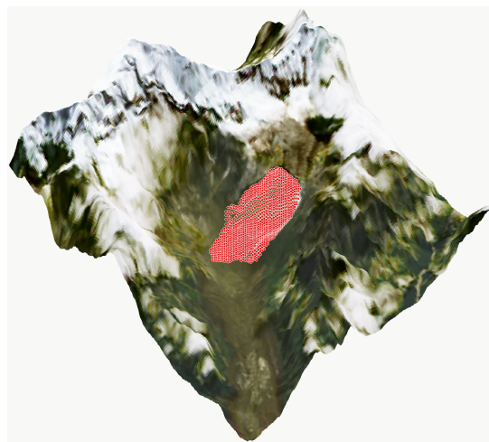
図3 崩落領域の3次元標高データに衛星画像をマッピングした画像(左)、および画像から同定して設定した崩壊域(右)
