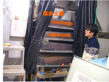
傾斜土槽を用いた汚水の浄化
