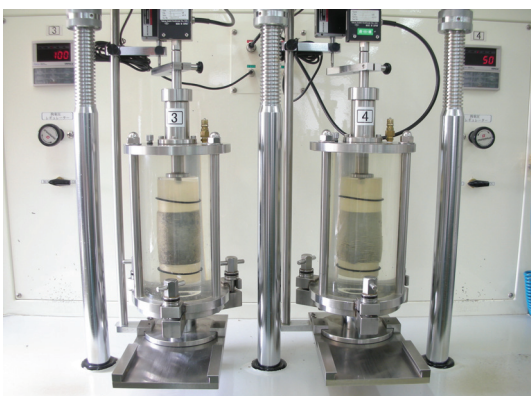
三軸圧縮試験：UU 室内土質試験（力学試験）
