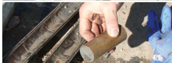
図-1.3.1 標準貫入試験の様子(写真左上)と用いるハンマー(右上)、2つ割りのサンプラー(中)と得られた土質試料の例(下)
