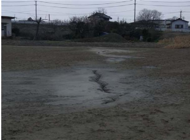
写真 23 液状化の痕跡（下平柳地区）
