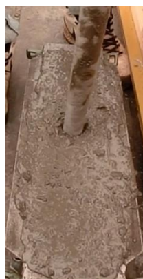
図 4-1 試験体作製方法 (バイブレーターあり)
