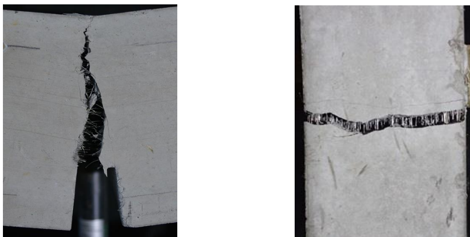
図 1-1 FRCC におけるひび割れ開口抑制（左：切欠き梁曲げ試験時，右：引張試験時）
