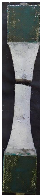
付図 3 一軸引張試験終了後のひび割れ面の様子 ( V_f = 1.0\% )
