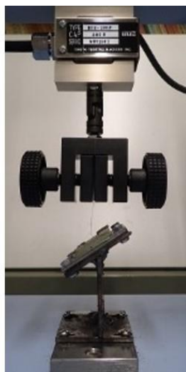
図 3-2 単繊維引抜試験加力方法（左：加力の様子，右：鋼板に固定した試験体）
