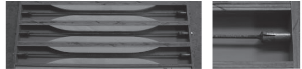
図 3 型枠および鉄筋接合状況
