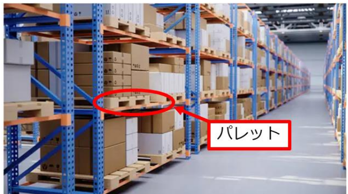
図-1 パレットラック [1]
