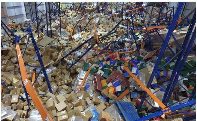
図-2 ラック崩壊事故後の被害の様子 [2]
