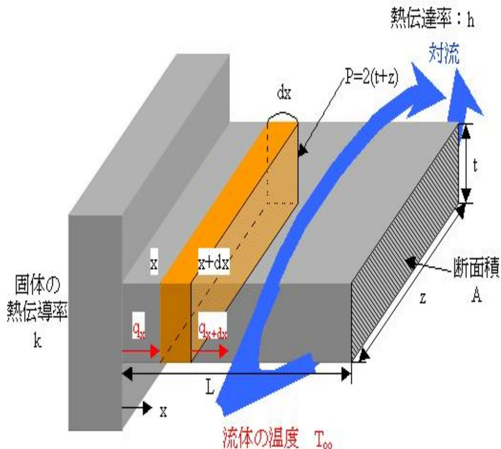
厚さ $t=3.0\text{mm}$ 、長さ $L=7.5\text{cm}$ のアルミニウム製( $k=200\text{W/m}\cdot\text{K}$ )フィンが左図のように壁についている。フィンの根元は $300^\circ\text{C}$ に保たれ、周囲の温度は $50^\circ\text{C}$ 、熱伝達率は $h=10\text{W/m}^2\cdot\text{K}$ である。フィンから放出される( $z$ 方向)単位幅あたりの放出熱量を計算しなさい。
