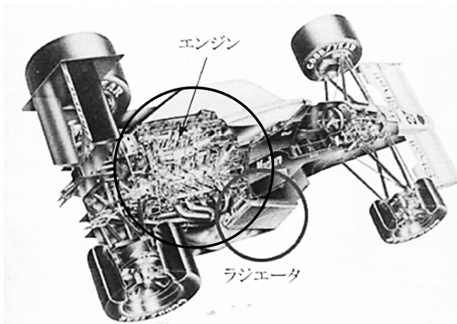
図 1.4 レーシングカーエンジンを冷却するためのラジエータ
