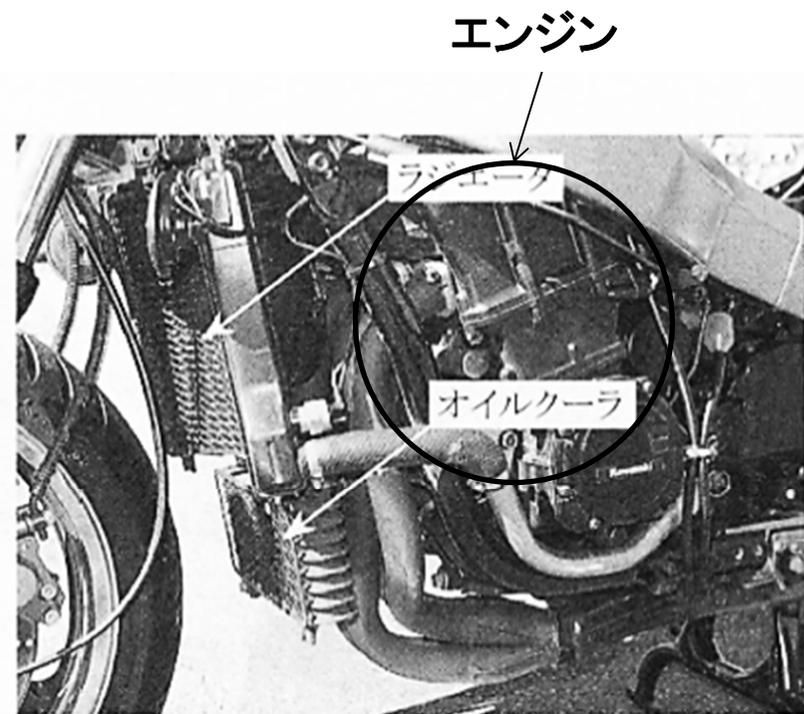
図 1.5 モーターバイクのラジエータとオイルクーラ (資料提供 川崎重工業株)
