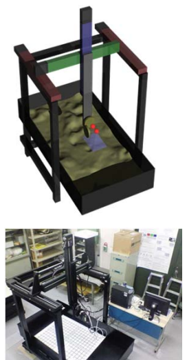
月面模擬地形による着陸シミュレーション実験装置
