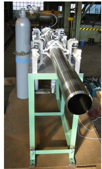
上の写真はパルスデトネーションロケット飛行試験機である。筑波大学はIHIAアロスペースエンジニアリング、宇宙航空研究開発機構(JAXA)と共同で開発をすすめている。このロケットエンジンは、デトネーション波を円管内に伝播させることで高エンタルピー気体を生成し、間欠的なジェット推進を行うことができる。単純構造かつユニークな推力特性を有する。本研究室では、滑走試験を経たのち、世界初の飛行試験を目指している。
