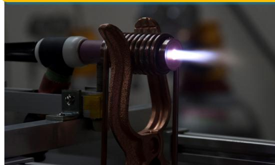
図: 1 kWクラスのプラズマトーチを用いた放電実験の様子 (Ar-N<sub>2</sub>混合ガス, 電流値100 A)
