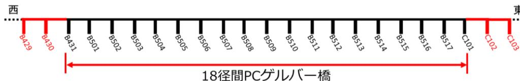
図2 18径間PCゲルバー橋の概略図
